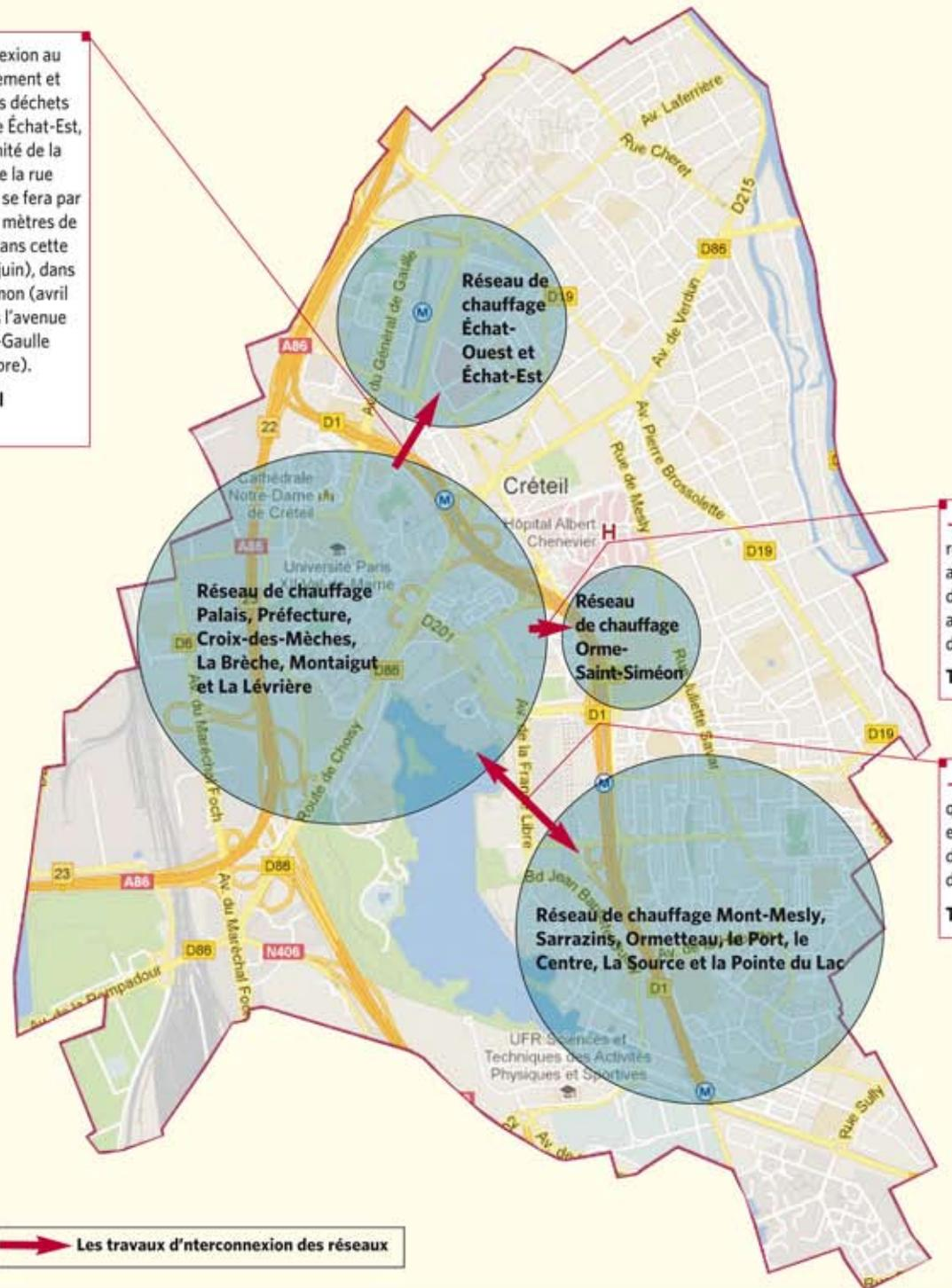
→ Le raccordement de la chaufferie, située rue de l'Orme-Saint-Siméon, au réseau de chaleur produit par l'usine d'incinération se fera par interconnexion avec le réseau existant de La Brèche. Il implique la pose de 520 mètres de canalisations sur l'avenue François-Mauriac (en avril et mai), aux abords et sous la bretelle de la voie rapide (mai à juillet) et aux abords de l'enceinte de la caserne des sapeurs-pompiers (juillet à septembre).
